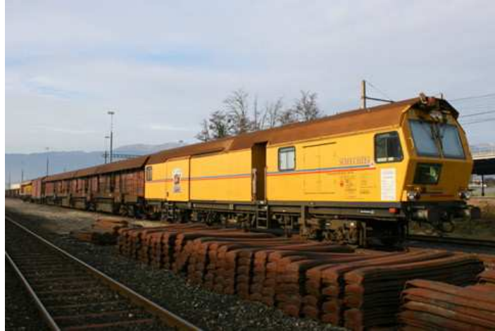
Train meuleur de rails (Scheuchzer S.A.)
